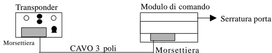
Con lettore CHIP cards e serratura elettrica.
