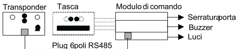
Con lettore CHIP cards e verso la serratura elettrica e/o il teleruttore luci.
